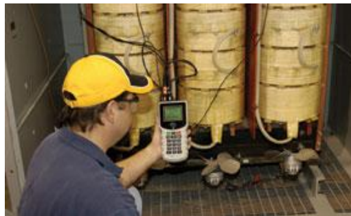
TTR Monofásico Automático (Fuente: Megger – Modelo TTR100)
